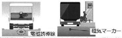
▲電磁誘導線や磁気マーカーによる自車位置特定による運行の補助
