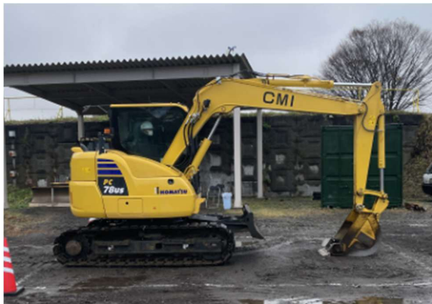
写真-1 油圧ショベルの駐機姿勢
